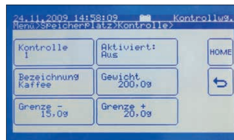
40 Speicherplätze pro Betriebsart bspw. für Checkweighing, Pretare, Referenzgewicht, Zielwert bei Dosierung, etc.
